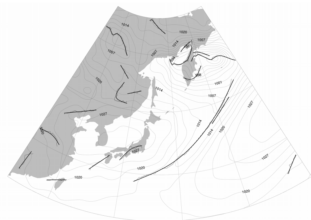
Рисунок 3. Результат разработанной технологии объективного распознавания фронтов и фронтальных разделов на 17.03.2018 г. 0:00 UTC. Применен критерий (4) с модифицированным алгоритмом выделения гребней.
